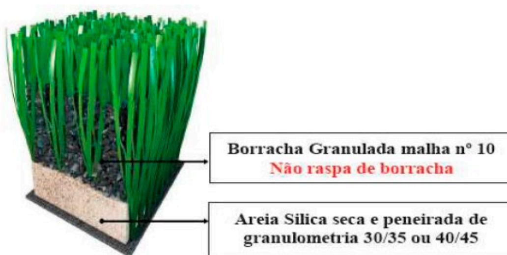
2.4 - A posição errada da fibra, em razão de equivocada forma de colocação da areia e borracha, sem o correto levantamento das cerdas, prejudicará significativamente a utilização do gramado; também haverá danos quando a grama não for devidamente penteada; a areia e borracha irregulares, causam a ocorrência de cisalhamento (Fenômeno de deformação no qual os fios da grama estão sujeitos quando as forças de atrito juntamente da areia, borracha e o jogo causam quando esses materiais de
