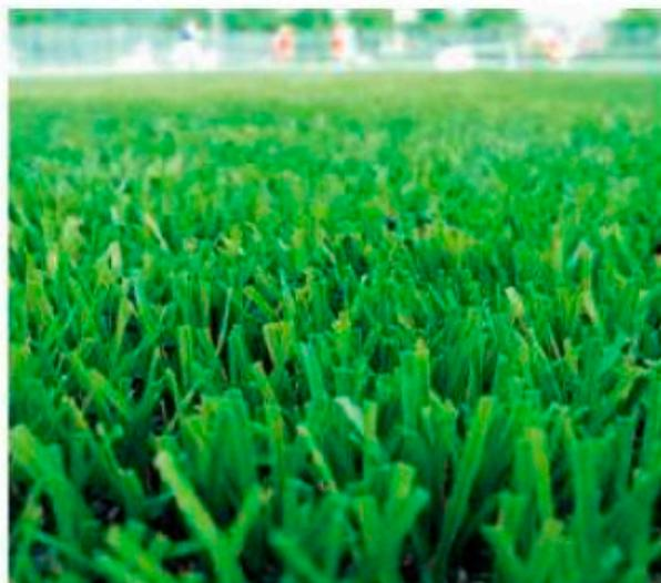
2.3 - A quantidade de areia sílica é determinante para manter a grama levantada, a qual deverá ficar entre 15-25mm.
